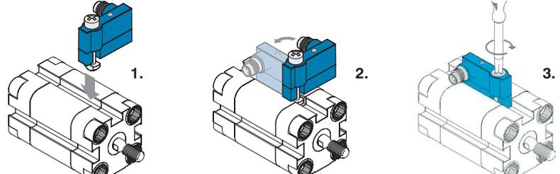
Von oben in die T-Nut einlegbar, mit Anschlussstecker M8 (z.B. Typ **Z-75721**).
