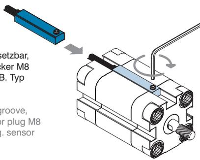
Seitlich in die T-Nut einsetzbar, mit Festkabel oder Stecker M8 nach 300 mm Kabel (z.B. Typ **Z-72832**).
